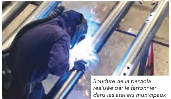
Soudure de la pergola réalisée par le ferronnier dans les ateliers municipaux
